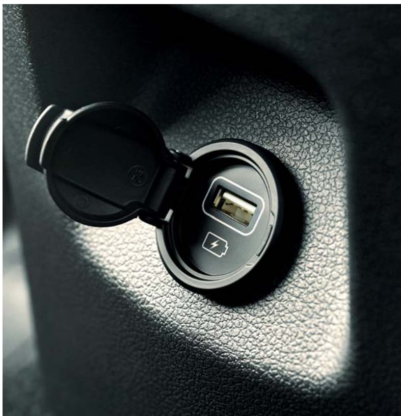
Zadný konektor USB – Konektor USB na nabíjanie mobilného telefónu je pre zadných pasažierov nainštalovaný v stredovej konzole.
