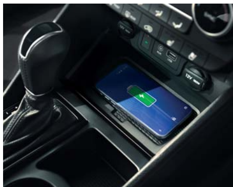
Bezdrôtové nabíjanie smartfónu, vstupy AUX-in a USB, ako aj zásuvka 12 V v bezprostrednom dosahu
