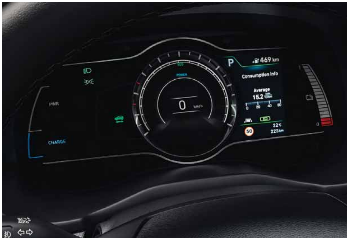
Nový združený prístroj 7" – Inovatívny digitálny združený prístroj s farebným displejom 7" (17,8 cm) zobrazuje rýchlosť, stav nabitia batérie a toky energie. Stačí jeden pohľad a vidíte, ako váš štýl jazdy ovplyvňuje dojazd.
