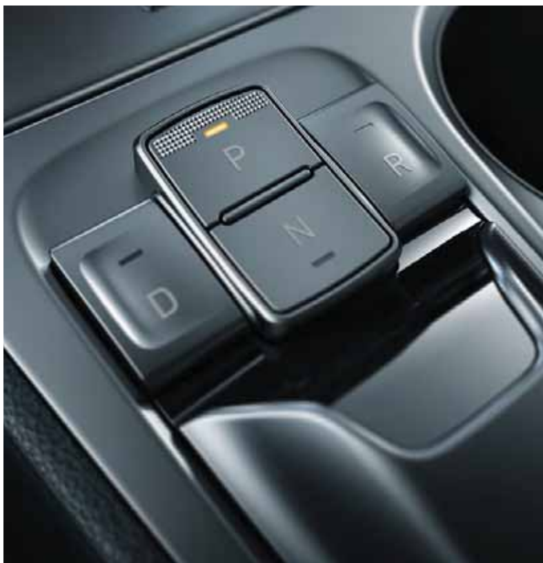
Tlačidlá shift-by-wire – Všetko, čo potrebujete, ovládate jedným prstom – pomocou tlačidiel pohodlne umiestnených na stredovej konzole môžete prepínať medzi jazdou dopredu, neutrálom, spiatočkou a parkovaním. V blízkosti je umiestnený aj ovládač elektrickej parkovacej brzdy.
