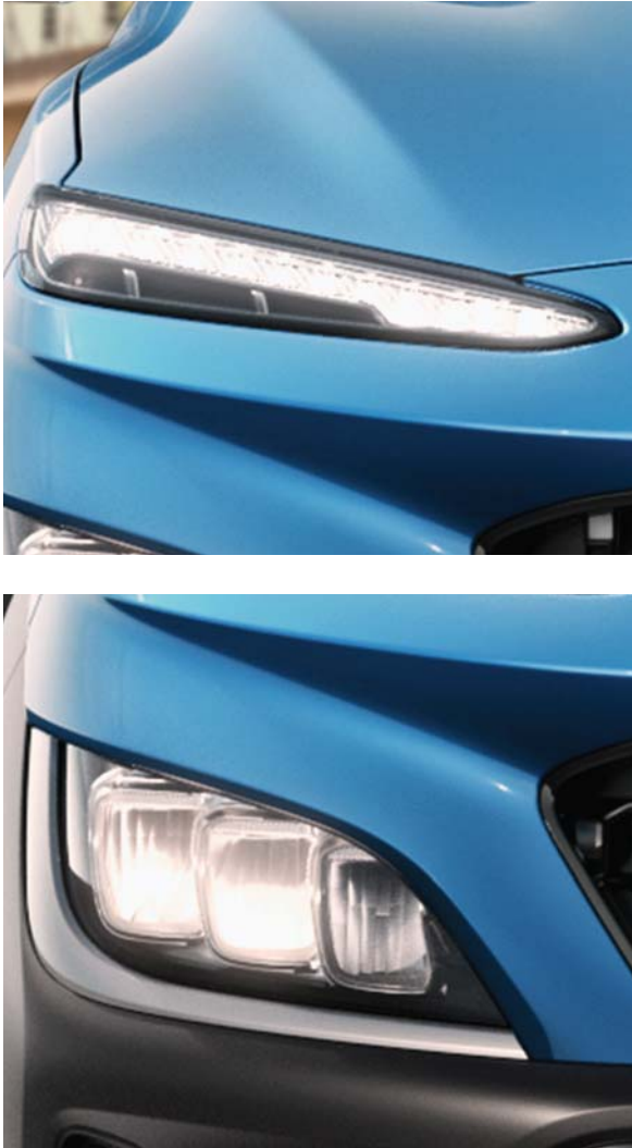
Úhľadný dizajn nových svetiel. Nápadná predná časť karosérie je úplne zmenená – vrátane charakteristických nových trojdielných LED svetlometov a úzkych denných svetiel na hrane kapoty.
