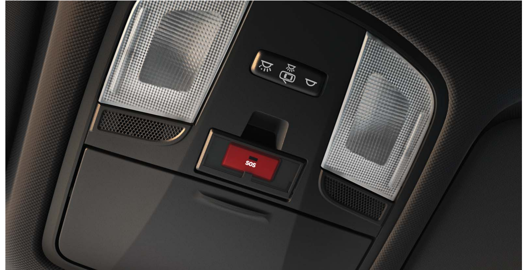
Tlačidlo e-call. Táto funkcia automaticky zavolá pomoc, keď sa pri nehode nafúknu airbagy. Okrem toho môžete pomoc v núdzi kedykoľvek zavolať aj stlačením tlačidla SOS.
