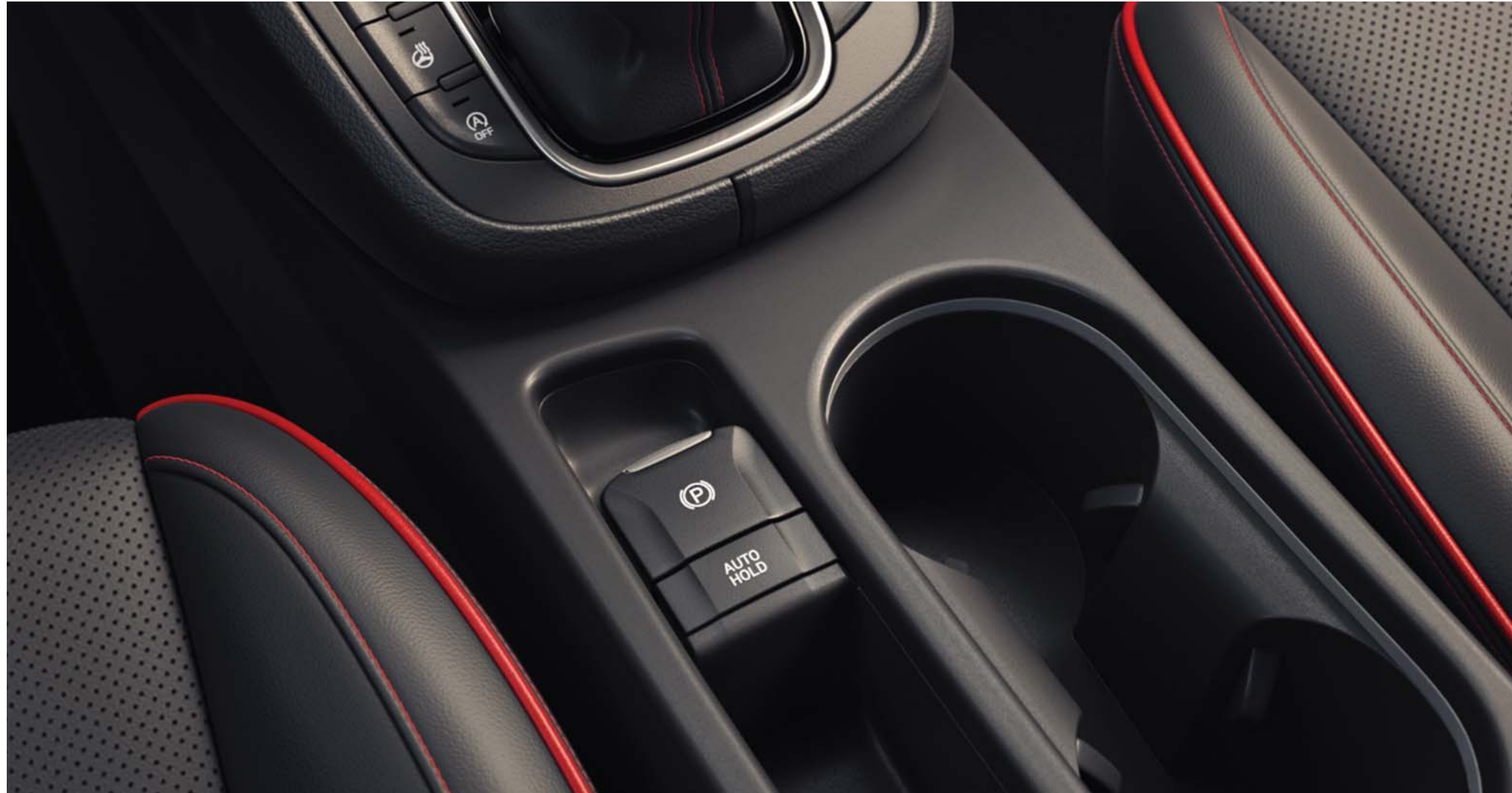
Elektrická parkovacia brzda. Ovládanie jedným prstom. Ovládač na stredovej konzole aktivuje a deaktivuje elektrickú parkovaciu brzdú. Inteligentná funkcia Auto Hold pri úplnom zastavení automaticky zabrzdí vozidlo bez toho, aby ste museli parkovaciu brzdú ovládať manuálne.
