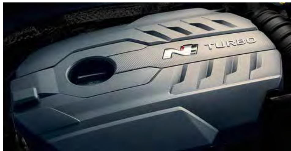
Novovvinutý motor 2.0 T-GDI má štandardne výkon 184 kW (250 k) alebo 202 kW (275 k) s kompletom N Performance Package.
