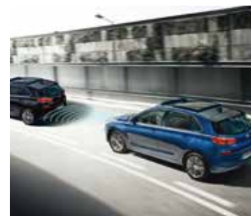
Adaptívny tempomat (ASCC) udržiava nastavený odstup od vozidla idúceho vpredu automatickým spomaľovaním alebo zrýchľovaním.
