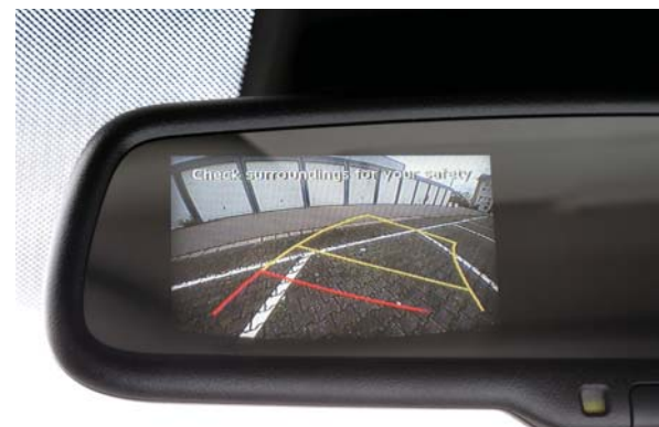
Cúvacia kamera. Uľahčuje cúvanie v obmedzenom priestore. Obraz sa prenáša na monitor vo vnútornom spätnom zrkadle.
