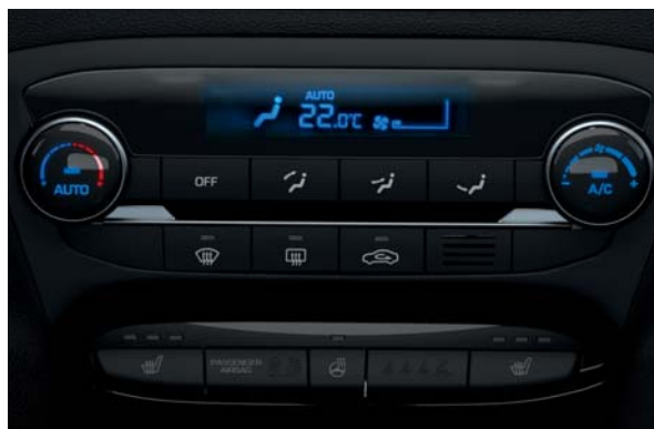
Automatická klimatizácia. Stačí nastaviť preferovanú teplotu a systém sa postará o ostatné. Funkcia automatického odhmlievania udržiava vo vlhkom počasi priehľadné okná.
