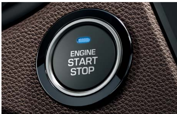
Tlačidlo na štartovanie/vypínanie motora. S kľúčom smart key v kabíne alebo vo vrecku sa motor dá naštartovať a vypnúť tlačidlom.
