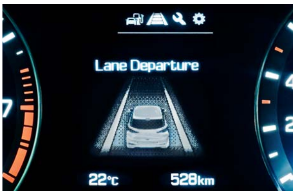
Lane departure warning system. Vizúálna a akustická výstraha pri neúmyselnom opustení jazdného pruhu.
