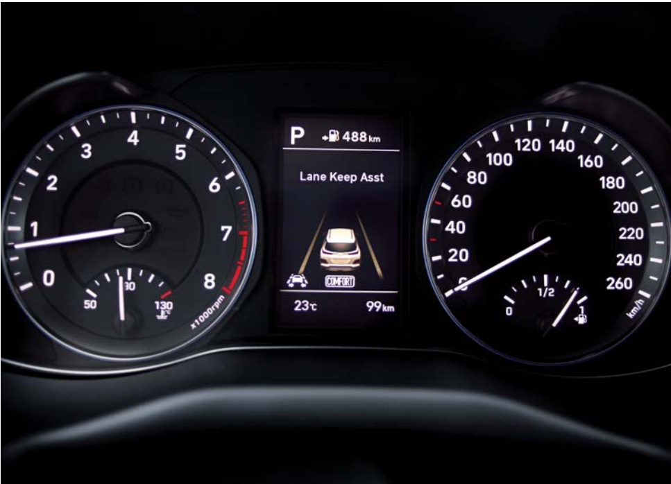
Digitálny informačný displej – Displej LCD s uhlopriečkou 10,7 cm (4,2") v združenom prístroji prehľadne zobrazuje dôležité jazdné informácie ako status aktívnych bezpečnostných systémov, dojazd, spotreba paliva, navigačné inštrukcie, vonkajšia teplota a ďalšie.
